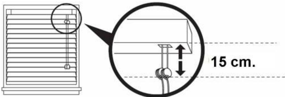
Si hay que realizar algún ajuste solo afloje el nudo del tapón hasta ajustarlo a la medida antes mencionada. Apriete nuevamente el nudo. Repita el proceso con ambos cordones.
