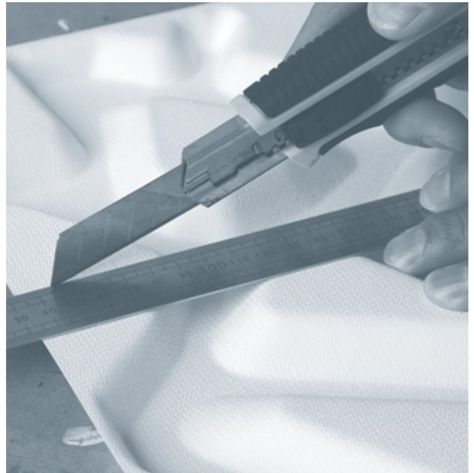
Repetir el corte inicial por un corte profundo en el panel.
